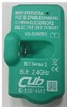
Рис. 4.1.1 Идентификатор колеса на датчике
