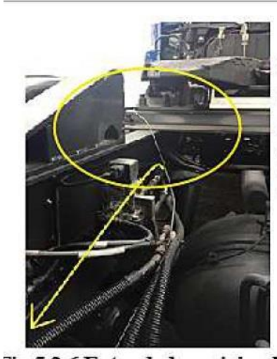
Рис 5.2.6 Закрепление расширенного приемного блока на заднем бампере грузовика
