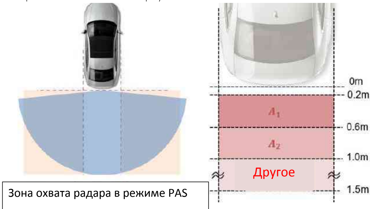
Рис. 3 Охват радара PAS и диапазон сигналов предупреждения
